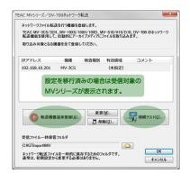
その中の 1 つを選択し、「接続テスト」ボタンをクリックすると、選択している MV シリーズ と通信を行い、設定が正しく行われているかを確認し、自動的に修正します。
