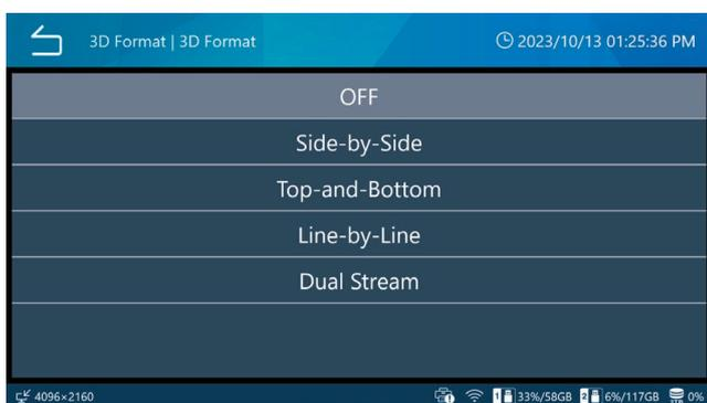
"Doppio flusso" (Dual Stream) è valido solo quando l'ingresso video del canale 2 è su "Acceso" (ON) in "Ingresso video avanzato" (Advanced Video Input). Immettere il video di sinistra in CH1 e il video di destra in CH2.
