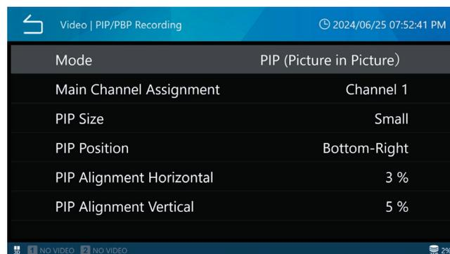
È possibile specificare la dimensione di incorporazione, il posizionamento e la posizione del canale secondario. Quando il video non viene registrato, può cambiare il canale principale pizzicando il pannello tattile (esclusa la modalità pannello tattile esterno 2).
